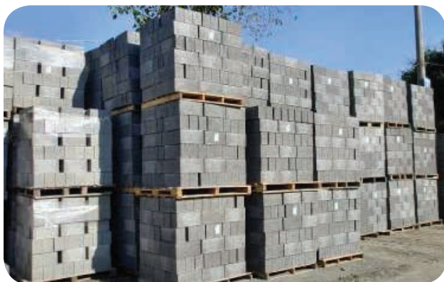
Depósito – blocos de concreto com ADF
