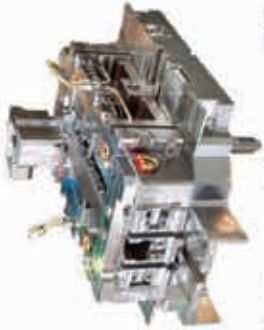
Coquilha para Cabeçotes ALUMÍNIO DE BAIXA PRESSÃO E GRAVIDADE
