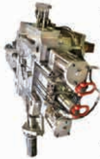
Molde para Comando de Embreagem INJEÇÃO DE ALUMÍNIO (HPDC)
