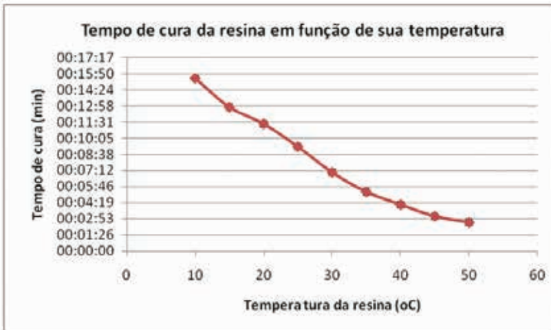
Gráfico 2 – Tempo de cura em função da temperatura para a resina normal.
