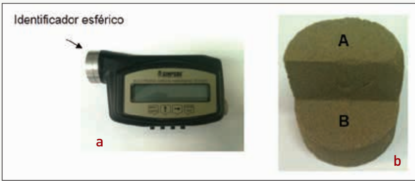
Figura 3: a) Medidor de dureza do molde em areia a verde tipo escala B e b) Os pontos de medição da dureza no corpo de prova padrão.
