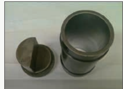
Figura 2: Ressalto na base do cilindro padrão AFS utilizado nas determinações da fluxibilidade Orlov.
