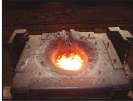
Figura 06 – Fusão em Forno à Indução.
