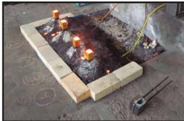
Figura 07 – Coletas das amostras de análise térmica de solidificação.
