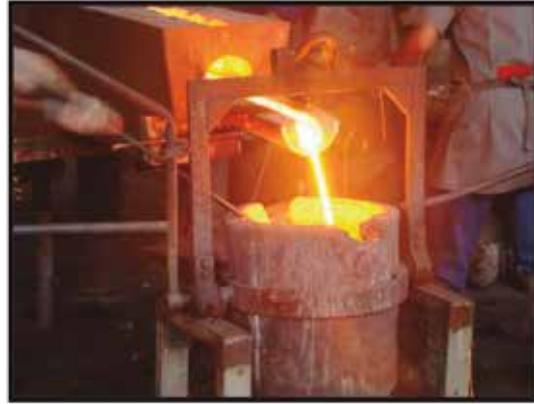
Figura 04 – Fusão em forno Cubilô.
