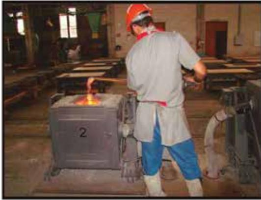
Figura 05 – Fusão em Forno à Indução.
