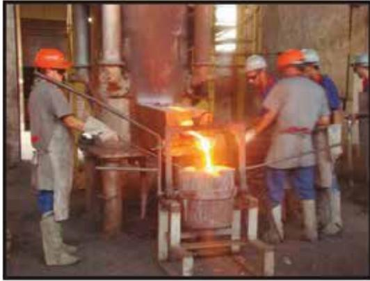
Figura 03 – Fusão em forno Cubilô.
