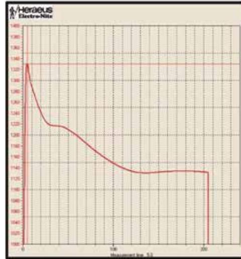
Figura 17 – Curva de resfriamento da condição “Forno à Indução”.
