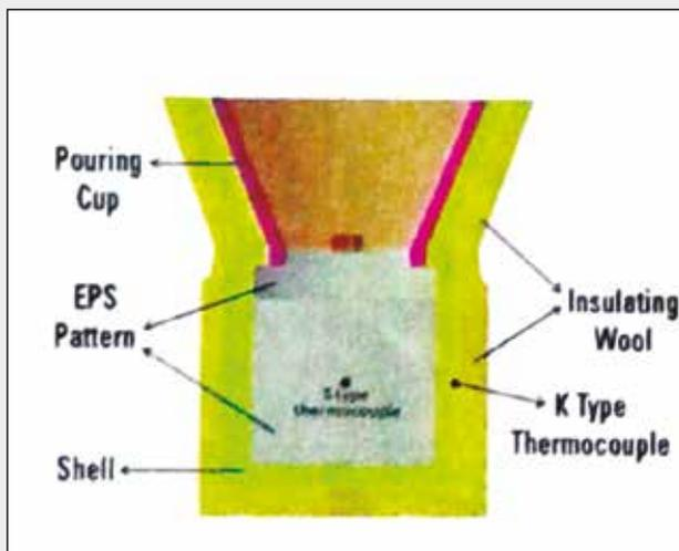
Fig. 1. O layout do arranjo de laboratório onde foram obtidos os resultados experimentais de temperatura.
