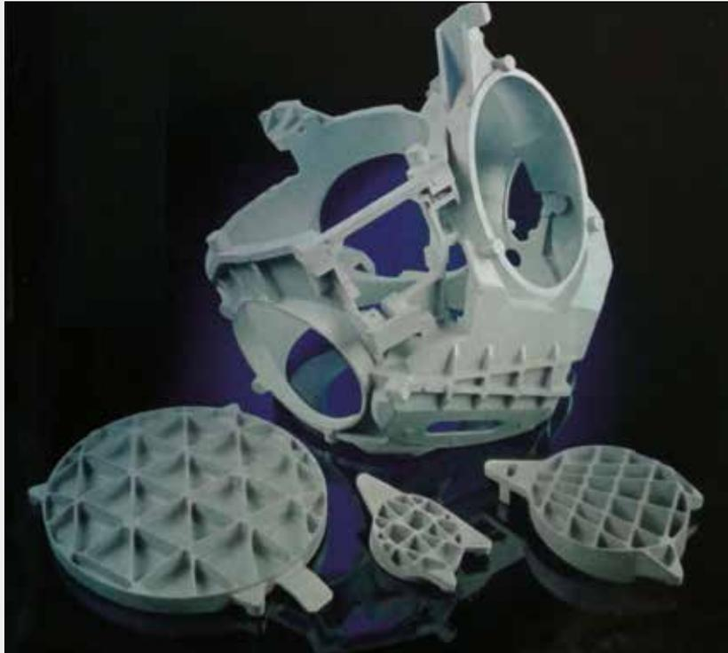
Esse conjunto de carcaça e espelho foi fundido em MMC (Compósito de Matriz Metálica) para um telescópio óptico leve de reflexão.
