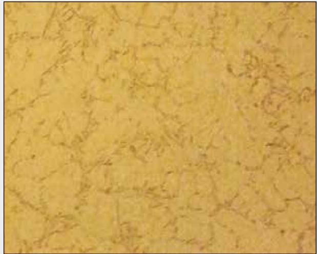
Fig. 7. É mostrada uma micrografia de uma liga A356 (sem ataque químico, 100x), sem as partículas de Carbetto de Silício, para comparar com as microestruturas de MMC.
