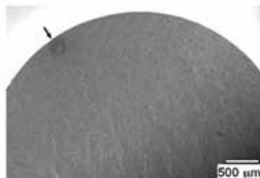
a) Início da trinca – fratura ‘olho de peixe’
