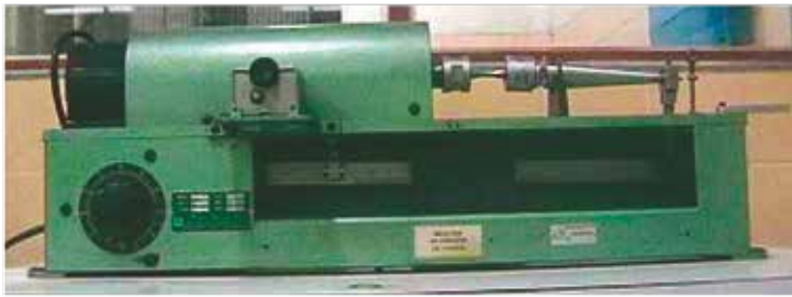
Figura 2. Máquina de ensaio de fadiga por flexão rotativa, Fatigue Dynamics Inc®RBF-200.
