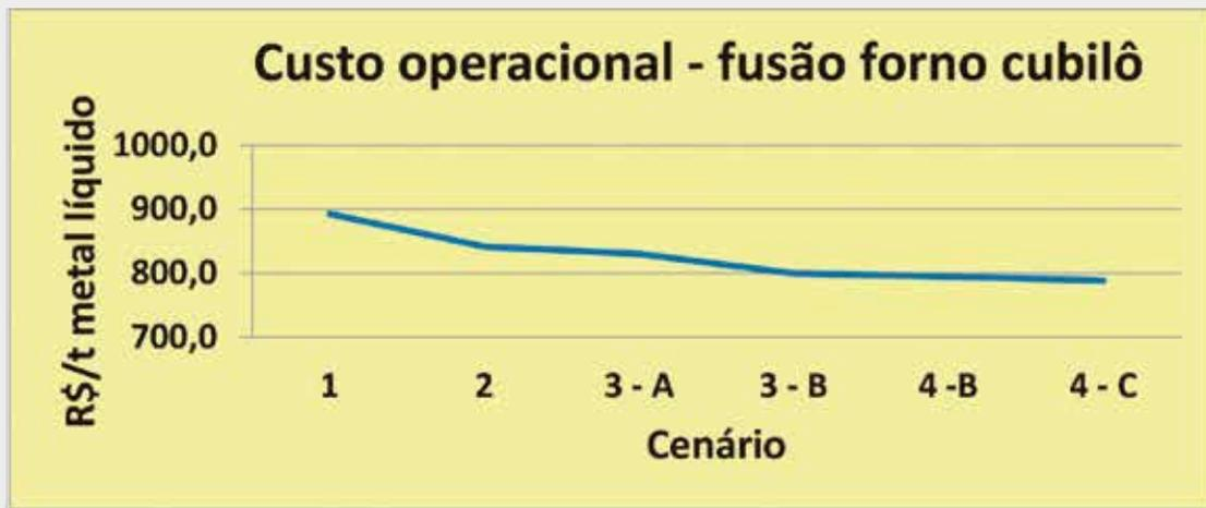
Figura 6 – Variação do custo operacional para fusão em forno cubilô em função da capacidade de produção
