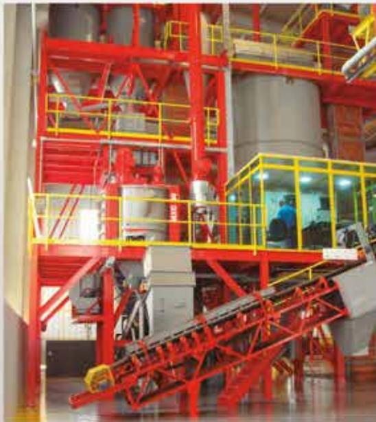
Os Sistemas de Preparação de Areia Mecaltec utilizam os Misturadores Super-intensivos comandados por inversores de frequência que otimizam o processo, resultando na melhor eficiência de mistura e redução no consumo de energia.
