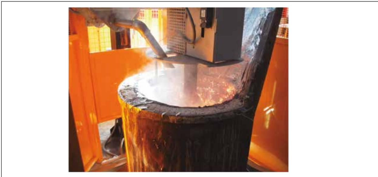
Figura 3. Tratamento de degasificação do alumínio com máquina automática
