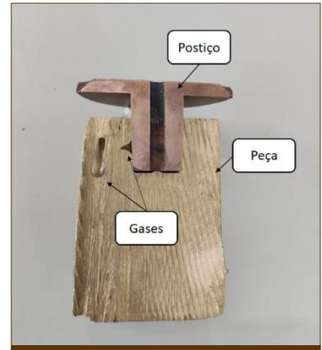
Fig. 16 – Vista em corte da relação postigo e peça com defeito. Os autores (2021).
