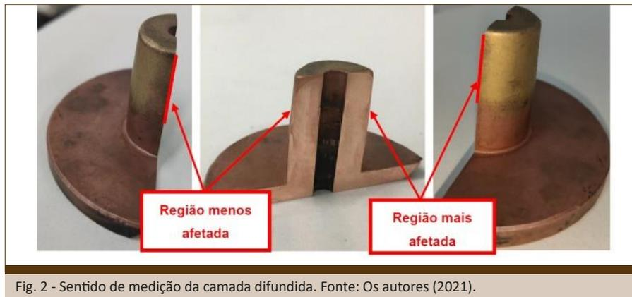
Fig. 2 - Sentido de medição da camada difundida. Fonte: Os autores (2021).
