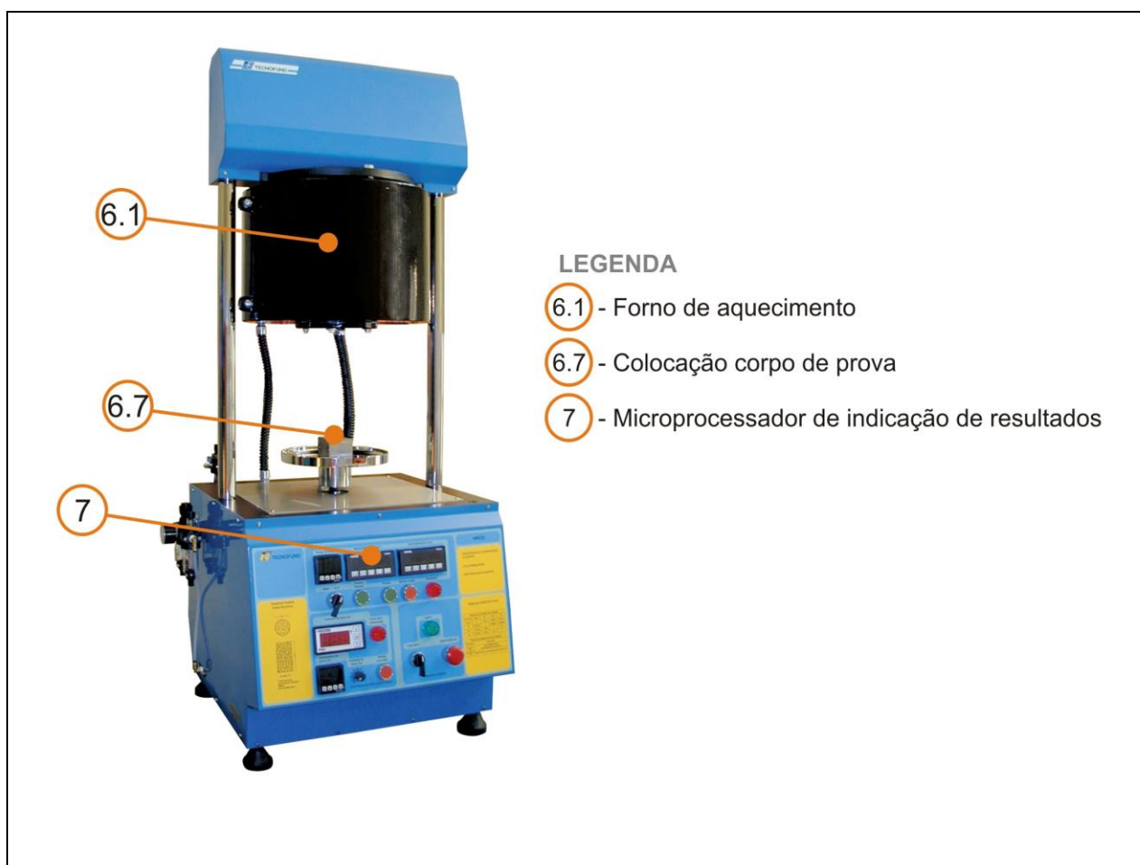
Figura 1 – Figura ilustrativa da máquina de resistência à compressão a quente.
