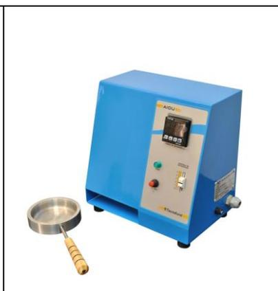
Figura 2 – Secador por lâmpada infravermelha
