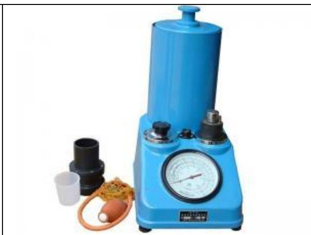
Figura 2 – Permeâmetro com manômetro
