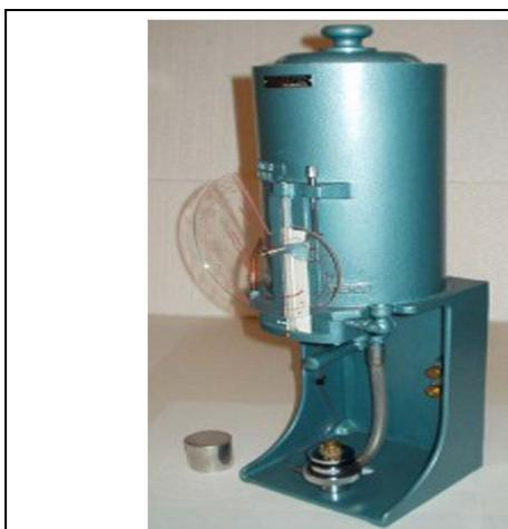
Figura 1 – Permeâmetro com coluna d'água.
