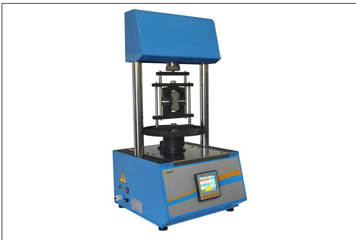
**Figura 3 – Foto ilustrativa de uma máquina de ensaios para ensaio de resistência à tração.**
