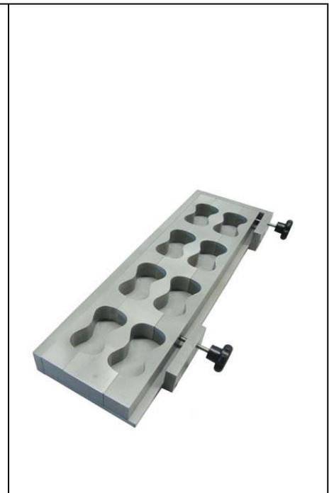
Figura 2 – Foto ilustrativa de uma caixa de macho para cura a frio.
