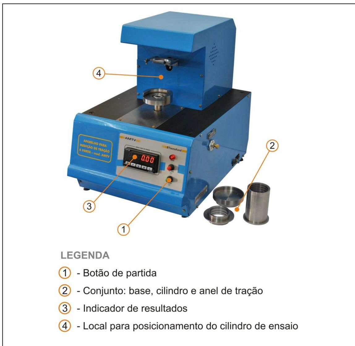
Figura 1 – Figura ilustrativa da máquina de ensaio de RTV.
