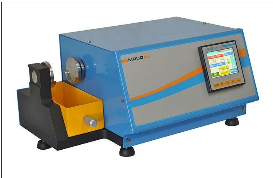
Figura 1 – Figura ilustrativa de uma máquina universal para resistência de areia.
