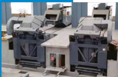
Carregamento de Forno com Exaustão
