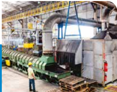
Desmoldagem e retorno de areia
