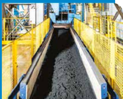
Transporte de areia preparada
