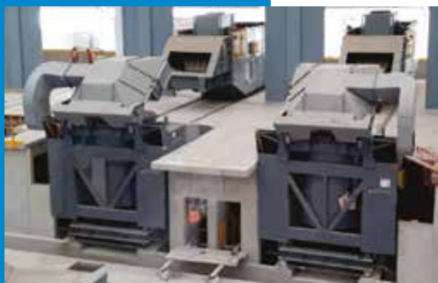
Carregamento de Forno com Exaustão
