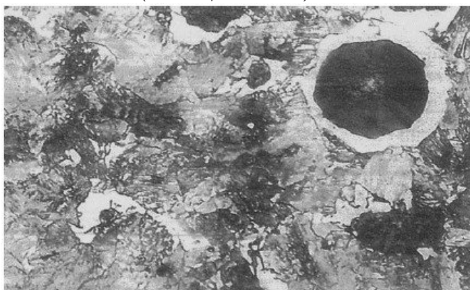
Figura 5 – Microestrutura com ataque de ferro fundido nodular obtido com adição de liga Ni - Mg em experiências de Millis na INCO (in ref Loper Jr, 2007).
