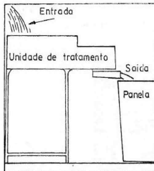
Figura 12 - Esquema mostrando o Processo Flotret de nodulização (Bakkerus & Holst, 1981).
