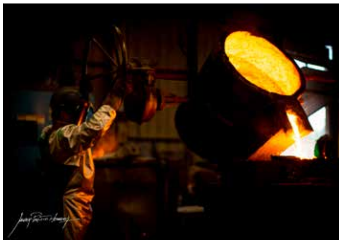
Equipados com dois fornos de indução avançados e com quatro cadinhos de 1 tonelada, a Usimontec é apta a produzir peças que variam de 20 kg a 2.300 kg líquido.
