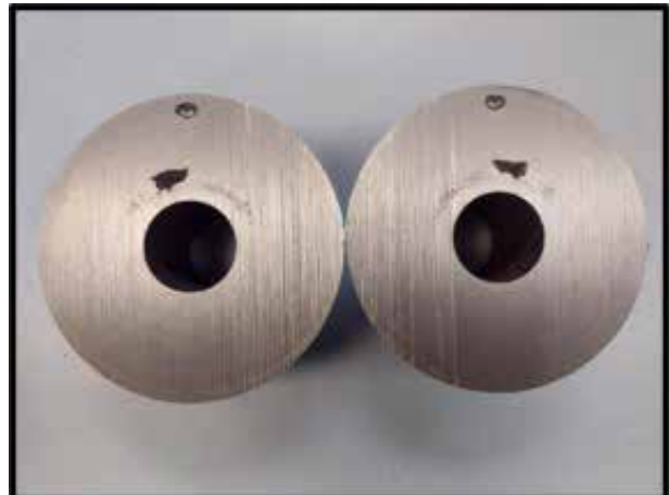
Figura 4: Análise macrográfica ilustrando posição do corte transversal (a) e peça cortada evidenciando a presença de porosidades (b)
