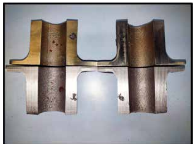
Figura 5: Análise macrográfica ilustrando posição do corte longitudinal a) e peça cortada evidenciando a presença de porosidades b)
