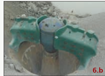
Figura 6: Esquema ilustrando o princípio de funcionamento de um britador giratório primário (a), vista do britador em funcionamento (b) e vista externa deste britador antes da sua instalação (c).
