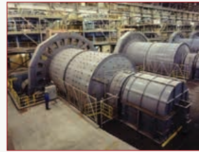
Figura 13: Aspecto geral de moinhos de bolas com cerca de 5 m de diâmetro, utilizados na moagem secundária de minérios.
