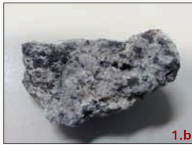
Figura 1: Distribuição irregular de pirita ( Fe_2S - amarelo) (a) e de sulfeto de cobre ( Cu_2S - preto) (b) em pedaços de rochas. Imagem de microscópio eletrônico de varredura de partícula de óxido/hidróxido de ferro (cinza) e illita (mais escuro) e finas inclusões de ouro (claras) (c).
