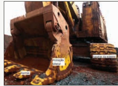
Figura 5: Foto ilustrando a utilização de peças fundidas resistentes ao desgaste como pontas, proteções laterais de caçambas e sapatas de esteiras em grandes escavadeiras.
