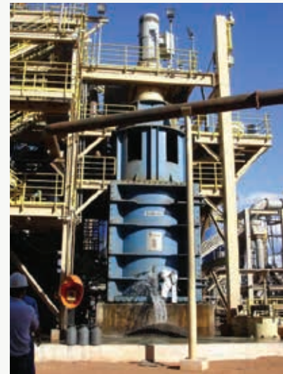
Figura 14: Aspecto geral de moinhos verticais (“Vertimill”) utilizados na moagem secundária de minérios.
