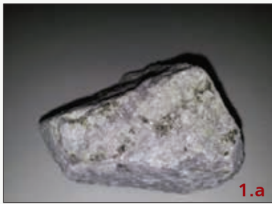
Figura 1: Distribuição irregular de pirita ( Fe_2S - amarelo) (a) e de sulfeto de cobre ( Cu_2S - preto) (b) em pedaços de rochas. Imagem de microscópio eletrônico de varredura de partícula de óxido/hidróxido de ferro (cinza) e illita (mais escuro) e finas inclusões de ouro (claras) (c).
