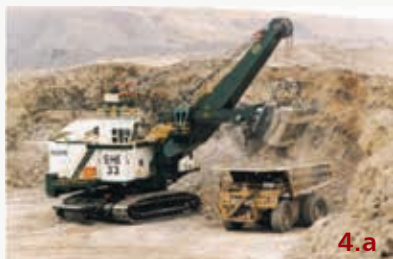
Figura 4: Escavadeiras utilizadas no manuseio de minérios: a) escavadeira tipicamente utilizada na extração de minérios friáveis, como minério de ferro; b) retroescavadeira utilizada no manuseio de minérios duros, como de cobre ou em pedreiras.
