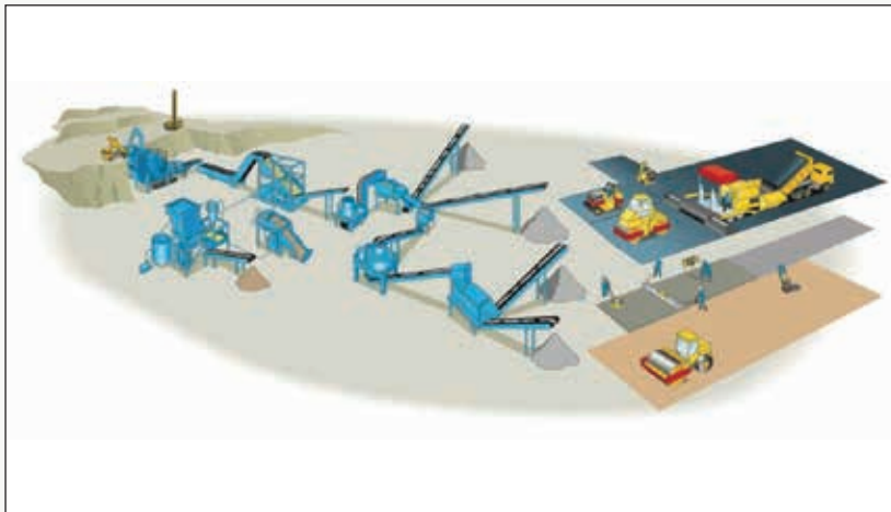
Figura 3: Fluxograma ilustrativo das operações que normalmente são utilizadas em pedreiras na produção de pedras britadas para o setor de construção civil (5) .
