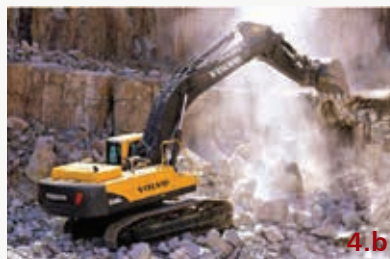
Figura 4: Escavadeiras utilizadas no manuseio de minérios: a) escavadeira tipicamente utilizada na extração de minérios friáveis, como minério de ferro; b) retroescavadeira utilizada no manuseio de minérios duros, como de cobre ou em pedreiras.
